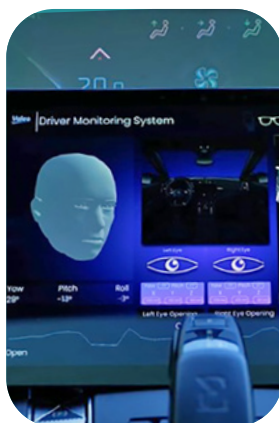
SURVEILLANCE DE LA CONDUITE
